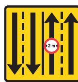
500 m Vognbaneforløb E 16.8.1 S 100 x 100 cm + 30 x 100 cm O 150 x 150 cm + 40 x 150 cm
