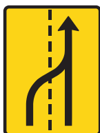
300 m Vognbaneforløb E 16.2.1 S 120 x 90 cm + 30 x 90 cm O 160 x 120 cm + 40 x 120 cm
